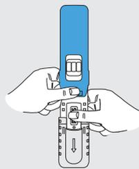
5. Placer le boîtier réactif en position verticale, l'ampoule vers le bas. **Appuyer fortement avec le pouce sur le bouton PRESS bien au milieu et en tenant le test bien droit** jusqu'à ce que l'ampoule cède. Maintenir le boîtier réactif en position verticale durant encore **10 secondes comme indiqué.**
