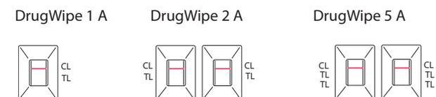
La coloration de toutes les lignes de contrôle en rouge confirme que le test est valide. Lorsqu'aucune ligne de test ne se colore en rouge, le test de dépistage est négatif.
