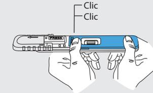
4. Coloque la tapa azul detectora de muestras de nuevo en el casete de tests. **La tapa azul detectora de muestras debe encajar en la ranura correspondiente tras un doble clic audible.**
