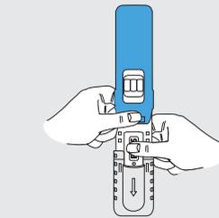
5. Mantenga el casete de tests en posición vertical con la ampolla en la parte inferior. **Coloque el pulgar horizontalmente sobre el centro de la palabra PRESS y presione con firmeza una vez hasta que se rompa la ampolla. Sujete el casete de tests durante 10 segundos más tal como se indica en la imagen.**
