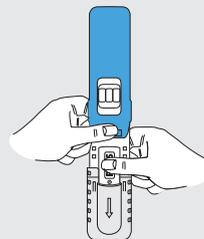
5. Testkassette mit der Ampulle nach unten halten. **Mit dem Daumen mittig und waagrecht 1x kräftig auf PRESS drücken**, bis die Ampulle zerbricht. Testkassette für weitere **10 Sekunden wie dargestellt halten.**
