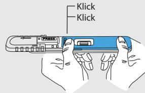
4. Probenehmer wieder auf Testkassette setzen. **Wischer müssen mit hörbarem Doppelklick einrasten.**
