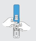
Testkassette mit der Ampulle nach unten halten. Mit dem Daumen mittig und waagerecht 1x kräftig auf PRESS drücken, bis die Ampulle zerbricht. Testkassette für weitere 10 Sekunden wie dargestellt halten.
