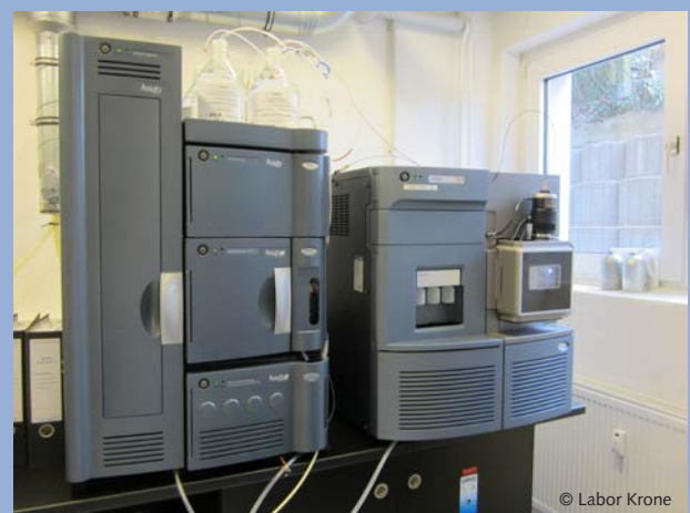
LC/MS-Analysensystem in einem forensischen Labor (hier: Labor Krone) links der Flüssigchromatograph, rechts das Massenspektrometer
